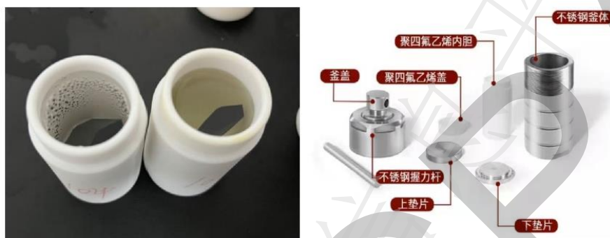
图 J. 1 \text{CO}_2 吸收剂腐蚀性测定反应釜及内衬示意图
